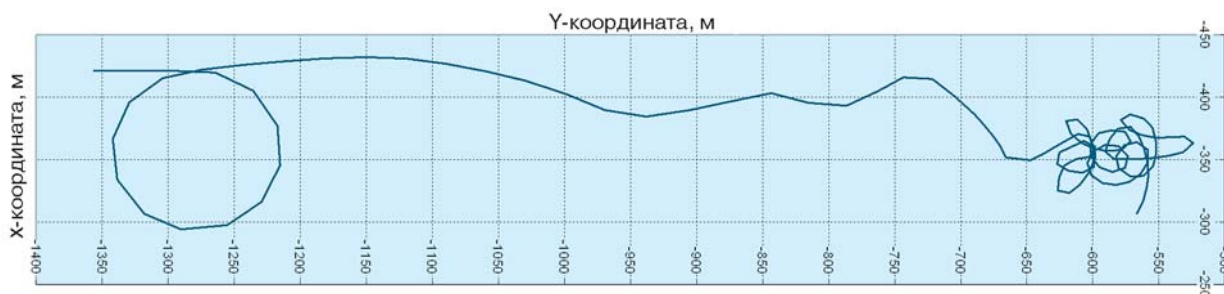
Рис. 2. Пример траектории автоматического приведения АНПА на судовую антенну
