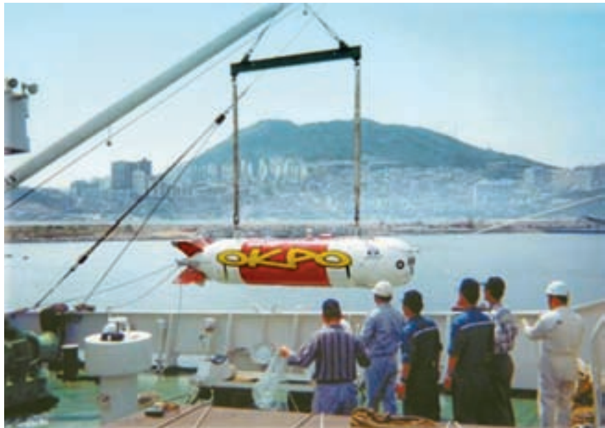
Рис. 5. Рабочий фрагмент морских испытаний АНПА «ОКРО-6000»
